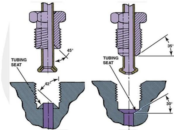
SAE INVERTED FLARE    ISO METRIC BUBBLE FLARE
